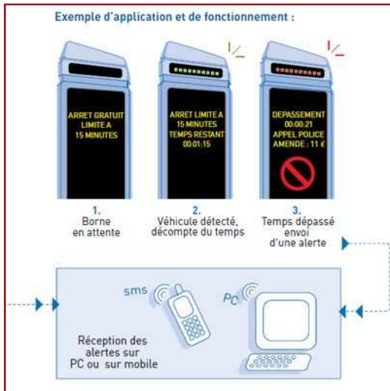
Fonctionnement du "statio minute" de Technolia
